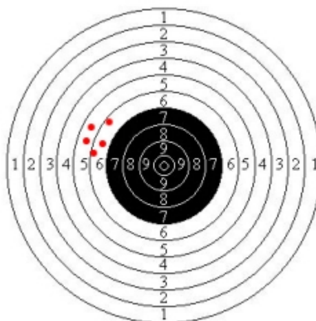
Bild 4. Denna träffbild som är mycket bra , flyttas in med hjälp av att skruva på riktmedlen.
